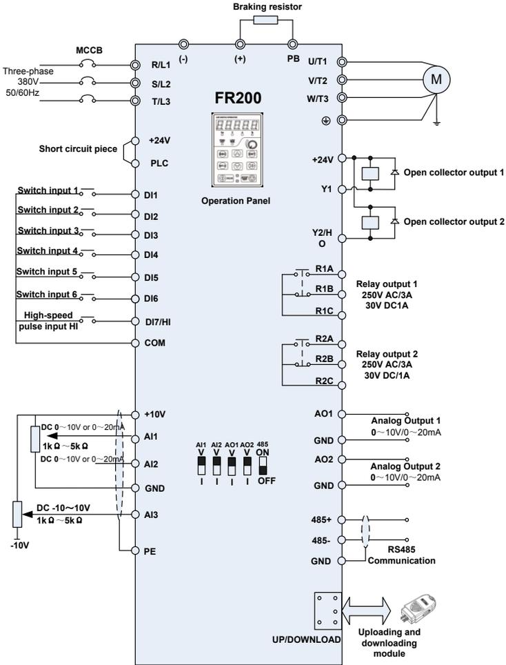
Fig.3-10 FR200 Inverter wiring diagram
